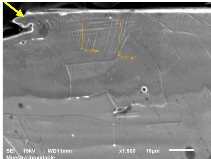
Figura 12. Microestructura en corte transversal a la superficie de maquinado de una muestra de acero inoxidable AISI 304. (imagen cedida por el Dr. Celso Cruz).
