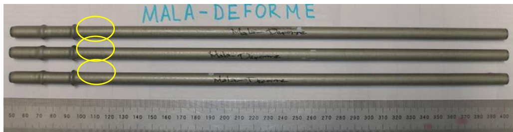
Figura 3. Conectores de acero AISI 1010 fabricados con defectos en la condición de entrega al laboratorio.
