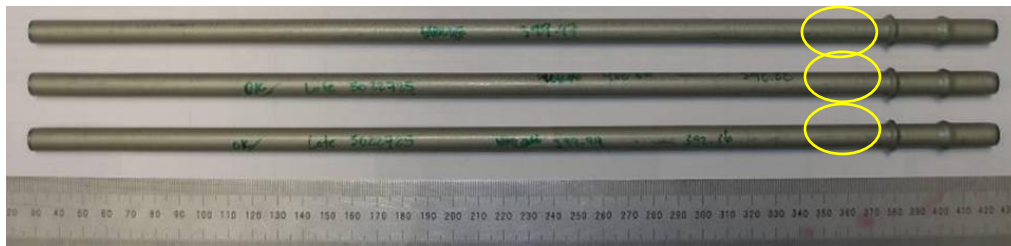
Figura 2. Conectores de acero AISI 1010 fabricados sin defectos en la condición de entrega al laboratorio.
