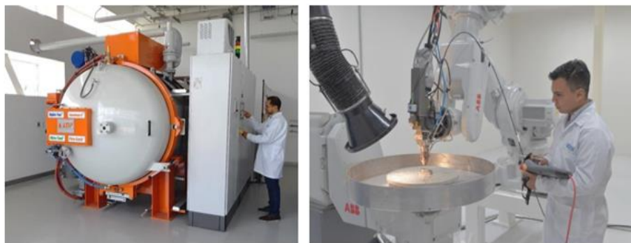
Figura 1: Horno de vacío para tratamientos térmicos y celda de MA CIDESI – Aeropuerto
